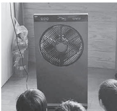
▲ミストファン 送風と同時にミスト（霧状の水）が吹き出す
