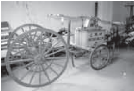
図1：消防組が使用していた手押しポンプ（写真左）。この後、手押しポンプから動力ポンプ（写真右）へと機械化が進む（いずれも中央公民館郷土資料室保管）
