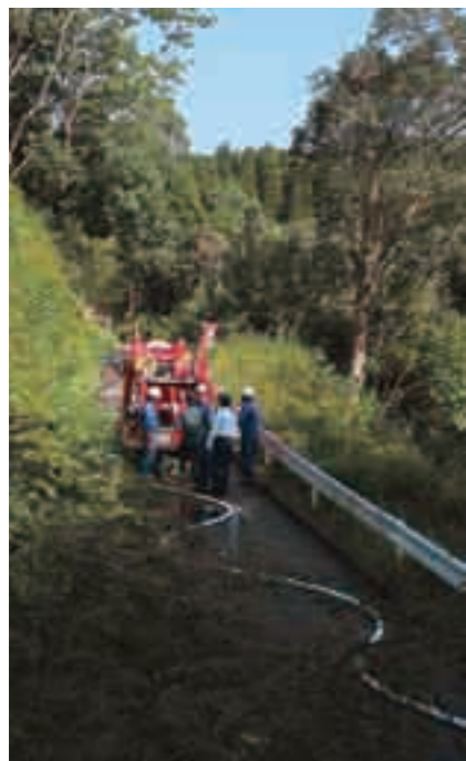
各部消防車両計7台で中継・送水を行う
